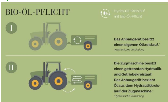
Abbildung 1: Übersicht zur Verwendung von Bio-Hydraulik-Öl in forstlichen Anbaugeräte
